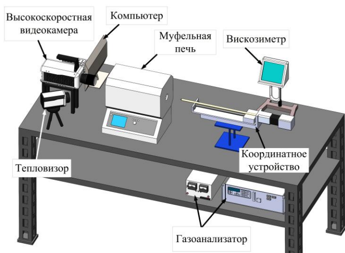
Рисунок 7 – Схема стенда для определения характеристик зажигания и горения композиционных жидких топлив
