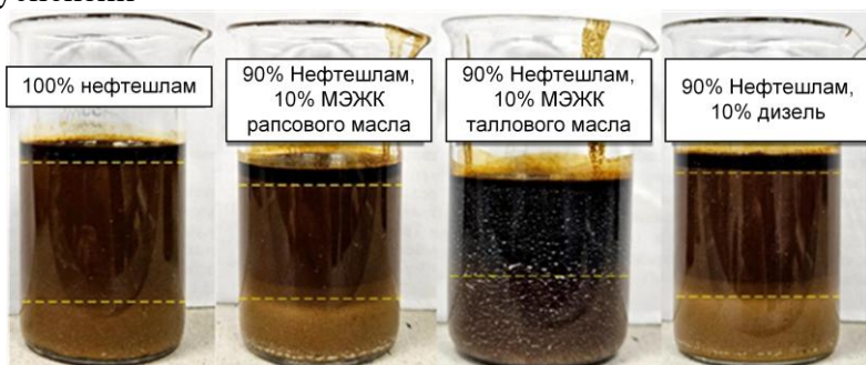
Рисунок 10 – Внешний вид топливных смесей на основе нефтешлама после статического хранения в течение 7 суток
